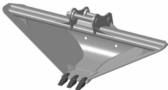
Профильный ковш позволяет значительно упростить и ускорить обустройство дренажных канав и кюветов. Особая форма наклонной боковой стенки позволяют рыть канаву трапециевидной формы за одну операцию одним ковшом.
