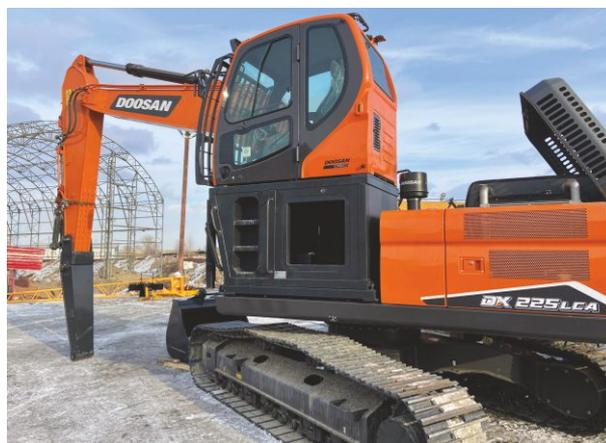
Установка лифт-кабины или проставки кабины подходит под любую модель экскаватора – Doosan, JCB, Caterpillar, XCMG, Komatsu, Hitachi, Hyundai, Liebherr, UMG и т.д.
