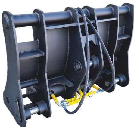
Предназначен для быстрой смены навесного оборудования - ковша, лесозахвата, поворотного и неповоротного отвала и др.
