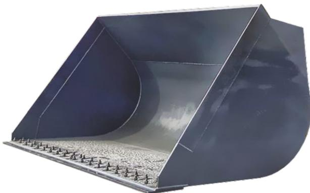
Ковш для легких материалов предназначен для работы с материалами плотностью до 1 100 кг. /м. куб. Ковш применяется при работе с такими материалами как: зерно, уголь, щепа, опилки, керамзит и т. д.
