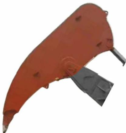
Устанавливается вместо стандартного рабочего оборудования на штатное посадочное место экскаватора. Состоит из укороченной стрелы с усиленным гидроцилиндром и рабочей части – рукоятки-рыхлителя со сменной коронкой.
