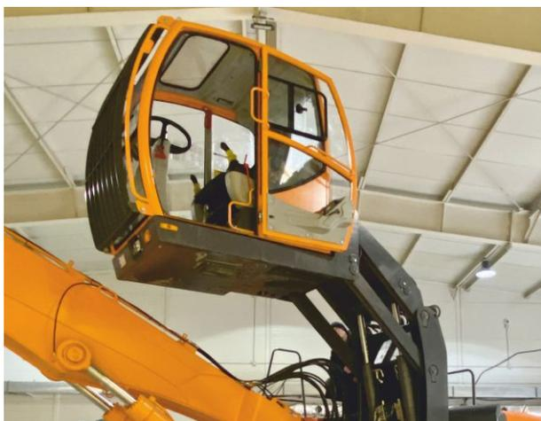
Установка лифт-кабины или проставки на экскаватор – услуга, которая широко применяется на предприятиях лесозаготовительной промышленности, в качестве замены хорвестеру (специальной лесозаготовительной техники). Установка гидроподъема кабины позволяет использовать экскаватор в качестве перегружателя.
